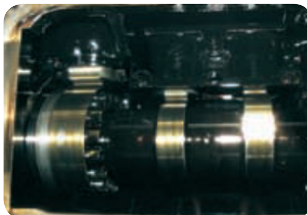
Eixo de cames com escurecimento típico
