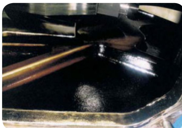
Cárter com escurecimento típico
